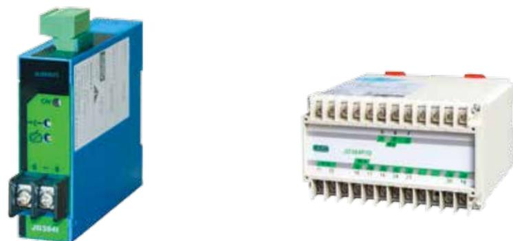
电量变送器是一种将被测电量参数（如电流、电压、功率、频率、功率因数等信号）转换成直流电流、直流电压并隔离输出的装置。产品符合国标GB/T13850-1998。
