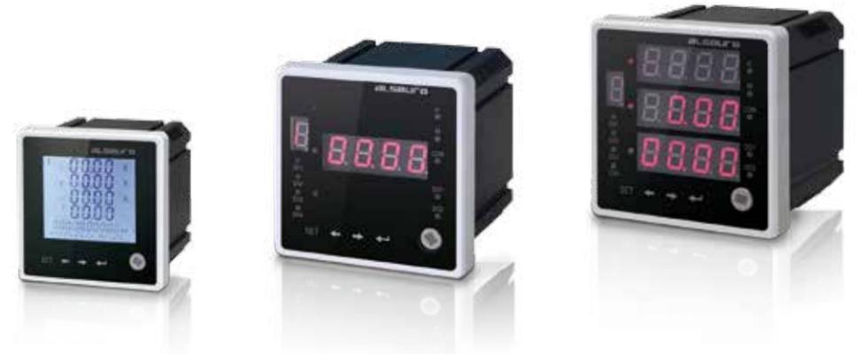
AEP600Z系列产品是一种具有可编程测量、显示、数字通讯和电能脉冲输出等功能的多功能电力仪表，能够完成电量测量、电能计量、数据显示、采集及传输，可广泛应用于变电站自动化、配电自动化、智能建筑、企业内部电能测量、管理、考核。测量精度为0.5级，实现LED现场显示和远程RS-485数字接口通讯、采用MODBUS-RTU通讯规约。
